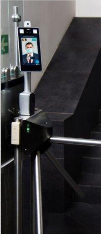
Для обеспечения универсального способа подключения современных биометрических считывателей (измерителей температуры, контроля наличия маски, паров алкоголя, распознавания лиц) был доработан интерфейс контроллера доступа «Борей». В результате появилась возможность подключать функциональность биометрических приборов к любой существующей СКУД по стандартному интерфейсу Wiegand. Мы назвали полученное решение – биометрический мультиплексор «МИП».
