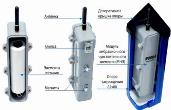
Размещение МЧЭ модуля в опоре заграждения
