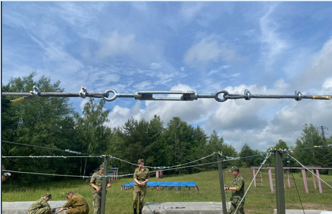
Узел крепления троса и талреп DIN 1480 кольцо- кольцо
