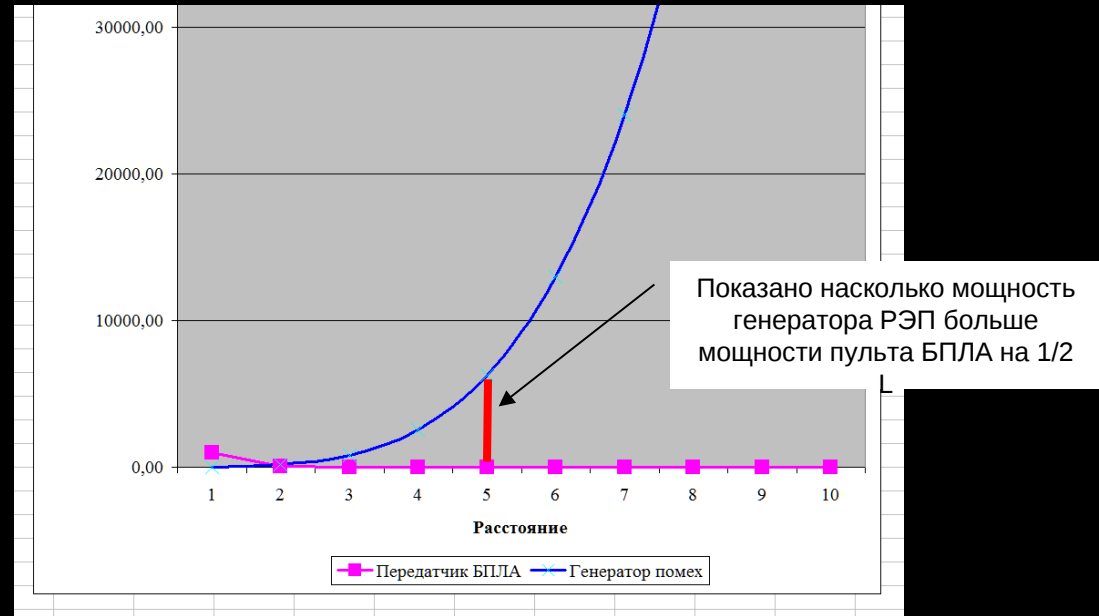
Рисунок 3 – Зависимость мощности генератора помех и пульта управления от расстояния (увеличено), мощность пульта БПЛА 1000 – мВт (1 Вт), мощность генератора помех – 100 000 мВт (100 Вт), ширина канала подавления и управления совпадают между собой
