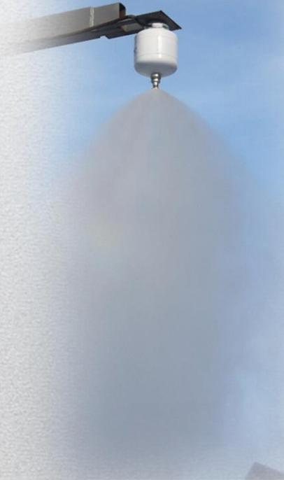
ИХГ нового поколения позволяют обеспечить низкую, с минимальными разбросами по времени, инерционность МУПТВ, не превышающую 2...3 с от момента подачи пускового импульса до начала выхода ОТВ, и поддержание постоянного давления в корпусе модуля в процессе выпуска ОТВ. Форсунка конструктивно выполнена таким образом, чтобы тонкораспыленный поток ОТВ при равномерном распределении обладал также высокой скоростью подачи в очаг пожара.
