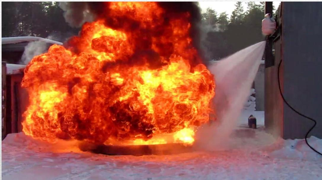
МУПТВ «Тунгус» предназначены для применения в качестве исполнительных устройств в автоматических установках пожаротушения. Кроме этого МУПТВ могут быть укомплектованы электронными узлами запуска, для работы в автономном режиме.
