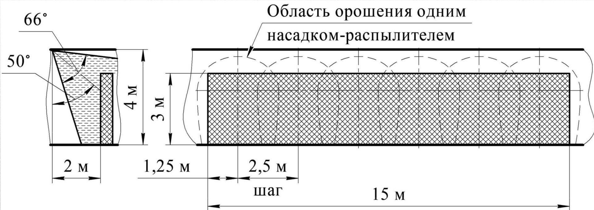
Противопожарная защита боковой поверхности стеллажа
