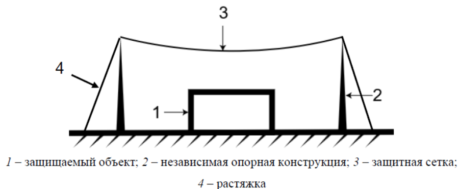
Рисунок 6.2 – Схема ЗОК на независимой опорной конструкции
