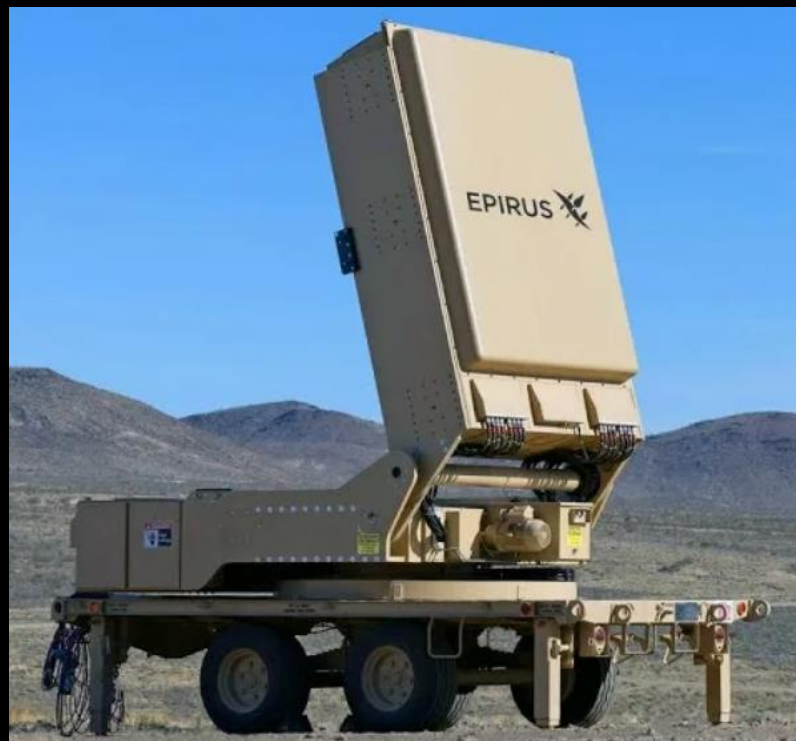
Генератор ЭМИ «Leonidas» от компании «Epirus» (США) (комплект на прицепе)
