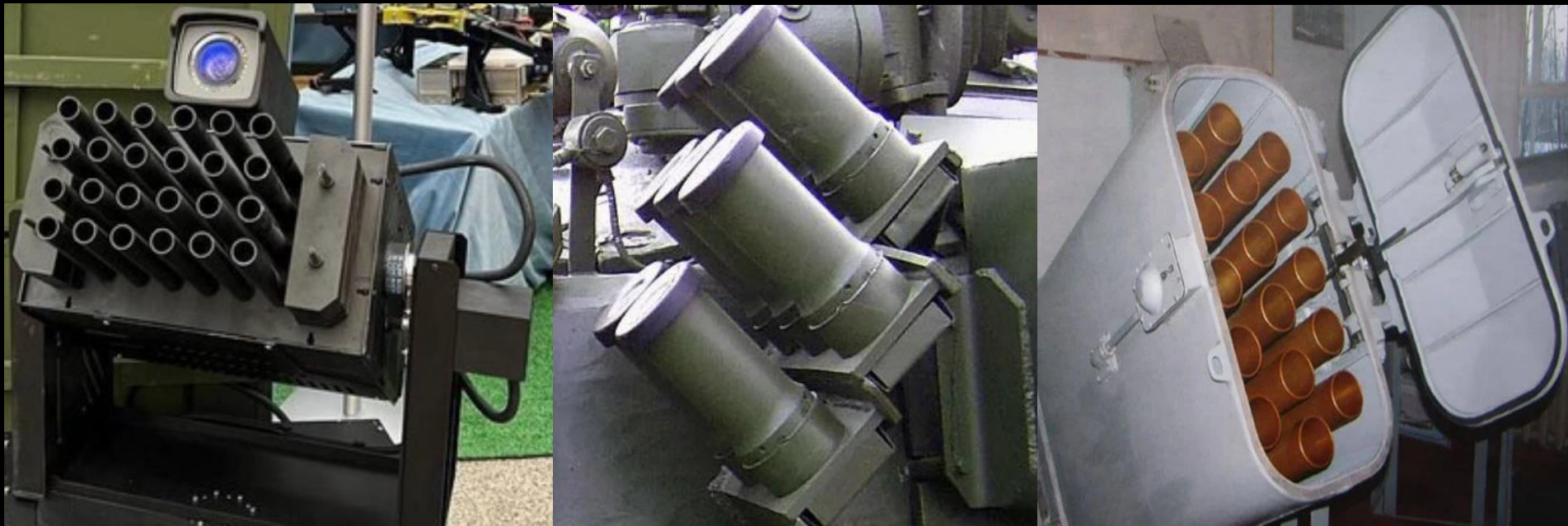
Слева 24 ствольная турель 12-го калибра, в центре танковый гранатомет постановки дымовой завесы (82-мм) , справа морской комплекс постановки помех ПК-16 (82-мм 16-ти ствольных ПУ)
