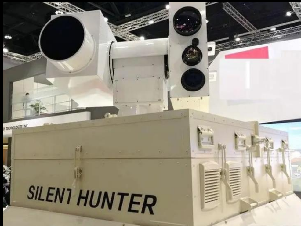
Комплекс поражения БВС на базе оптоволоконного лазера «SILENT HUNTER» (Китай)
