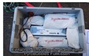
Контейнеры для перевозки неисправных ВВБ и ЛИА с противопожарными и теплоизолирующими веществами
