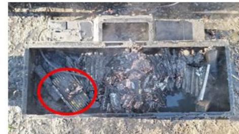
В ВВБ после инициирования теплового разгона была потушена, температура понижена. После тушения остались 9 ЛИА с первоначальным напряжением и без повреждений, что свидетельствует об остановке процесса горения.
