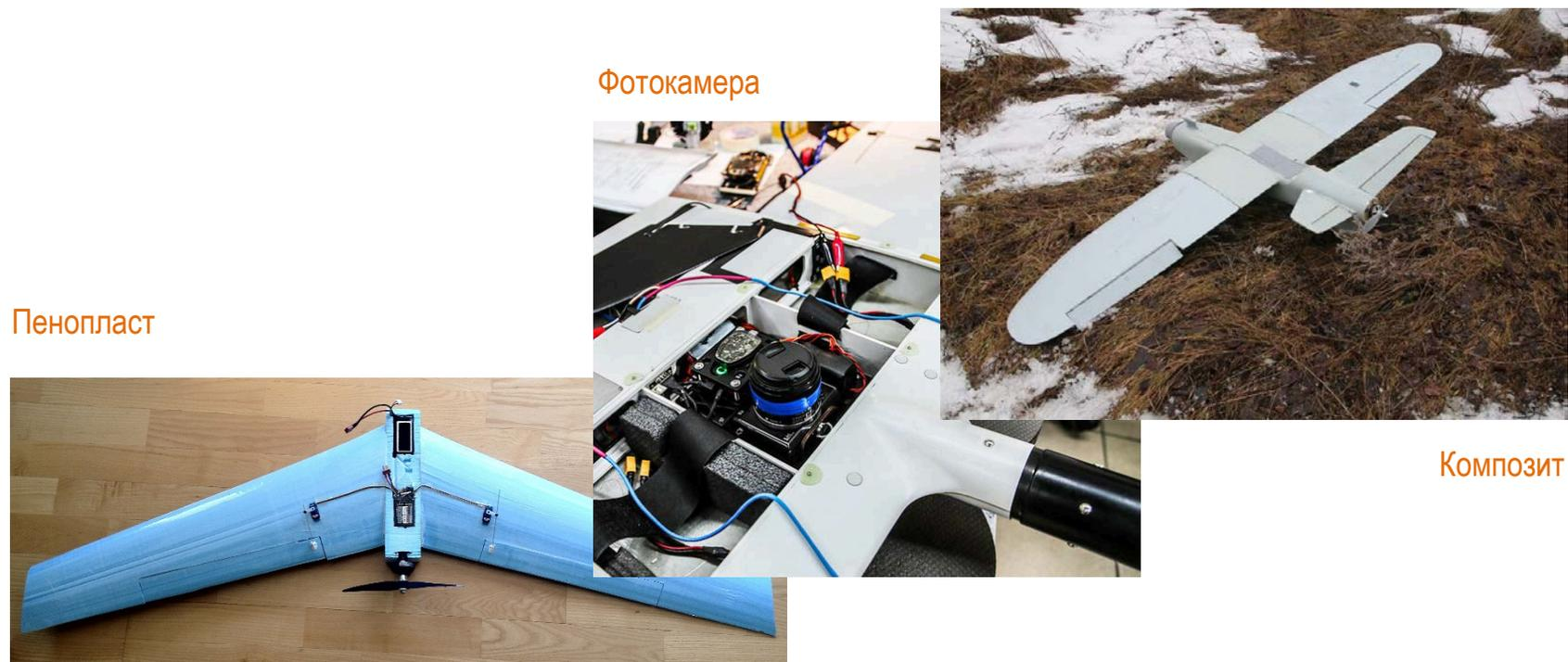
Электрический самолет – отсутствие боевой части, наличие одного или нескольких фотосенсоров, малошумный двигатель, запись во внутреннюю память и/или канал передачи видео с шифрованием на расстояние до 60 км, радиопрозрачность корпуса для снижения заметности на РЛС. Время полета до 2-х часов. Радиус действия до 100 км. Запуск с руки или катапульты. Обычно автономный полет.
