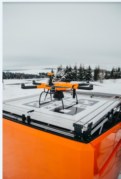
Автономная система хранения, взлёта и посадки БВС
