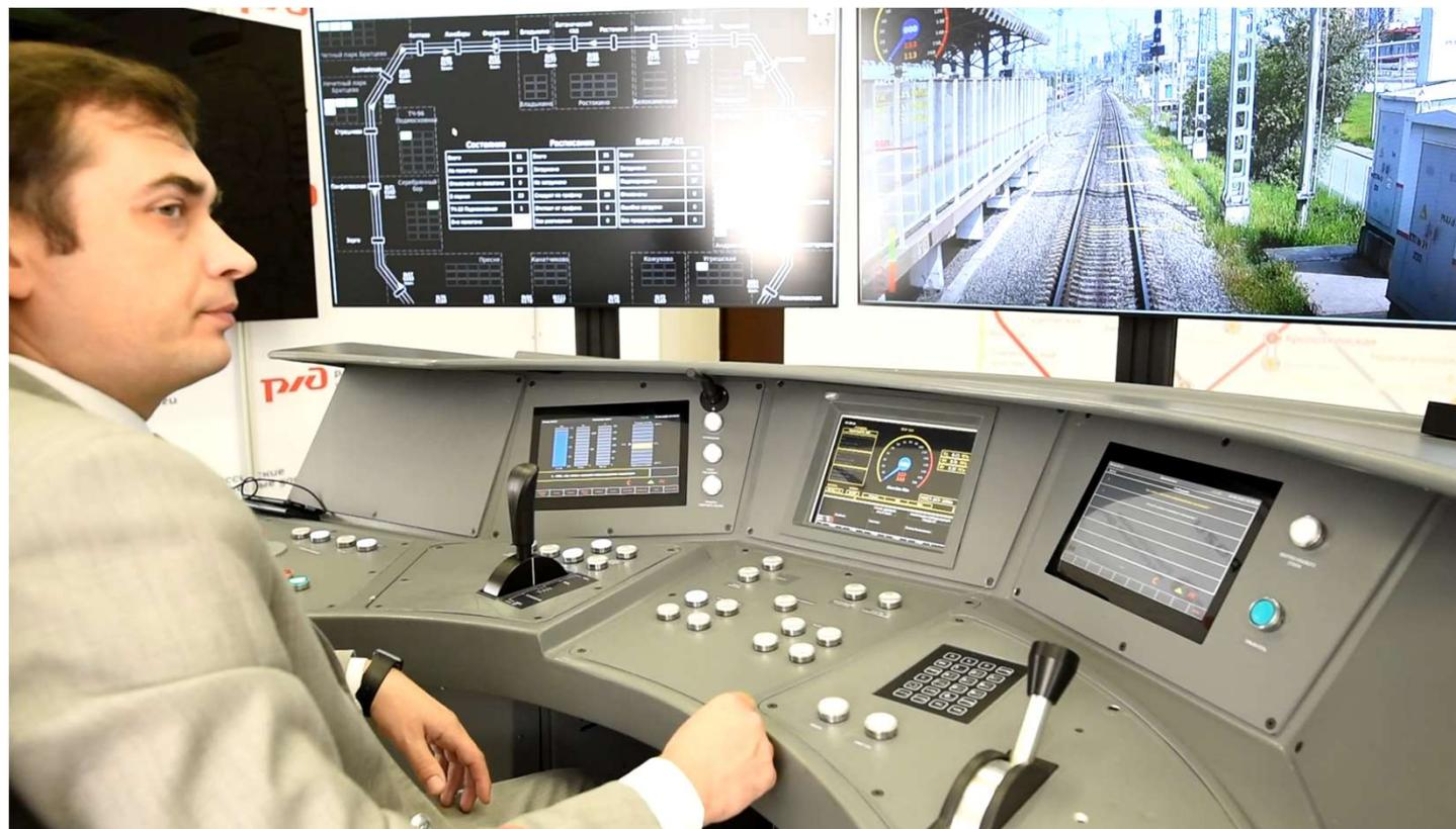
Машинист-оператор одновременно контролирует до 10-ти электропоездов и может управлять одним электропоездом дистанционно
