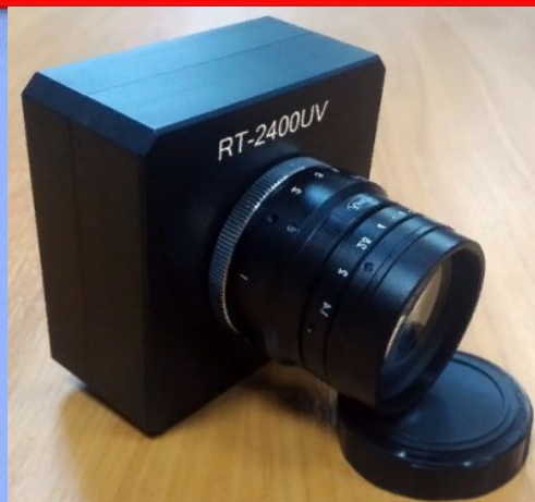
УФ камера RT-2400UV расширенного спектра 0,2 - 1,1 мкм
