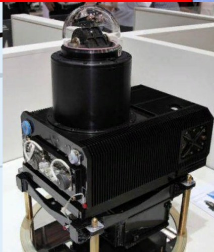
Лазерная станция оптико-электронного подавления комплекса «Президент-С»
