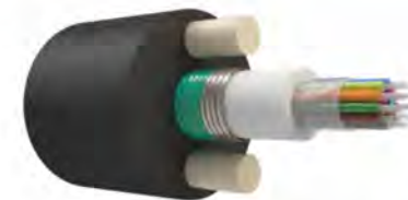
КАБЕЛЬ ОПТИЧЕСКИЙ В КАНАЛИЗАЦИЮ С ЦТ, ПЕРИФЕРИЙНЫЕ СИЛОВЫЕ ЭЛЕМЕНТЫ СТЕКЛОПЛАСТИКОВЫЕ ПРУТКИ, БРОНИРОВАННЫЙ СТАЛЬНОЙ ЛЕНТОЙ
