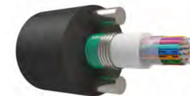
КАБЕЛЬ ОПТИЧЕСКИЙ В КАНАЛИЗАЦИЮ С ЦТ, ПЕРИФЕРИЙНЫЕ СИЛОВЫЕ ЭЛЕМЕНТЫ СТАЛЬНАЯ ПРОВОЛОКА, БРОНИРОВАННЫЙ СТАЛЬНОЙ ЛЕНТОЙ
