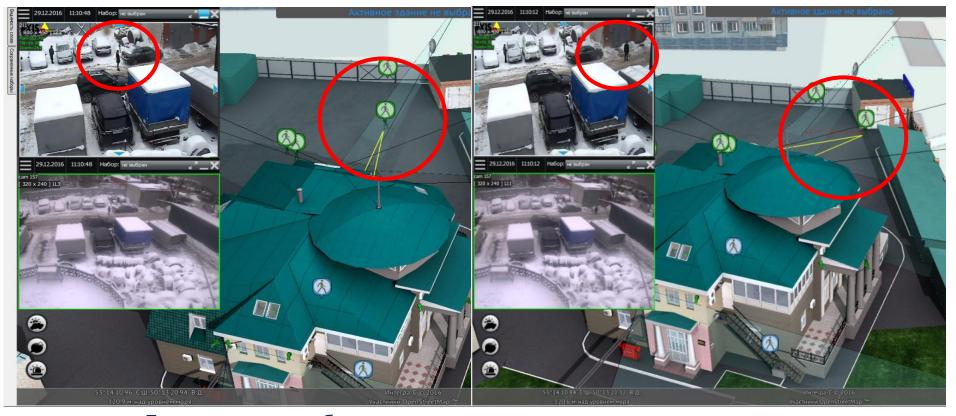
Привязка видеоизображения к координатам пространства и времени (пример - отображение перемещения человека с использованием трекера)
