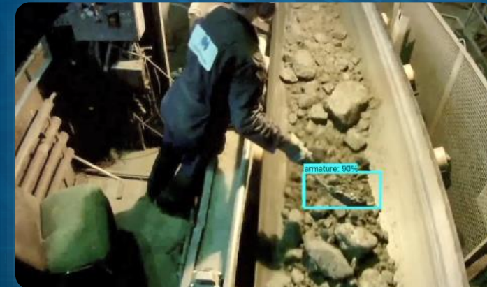
Контроль целостности ленты конвейера
