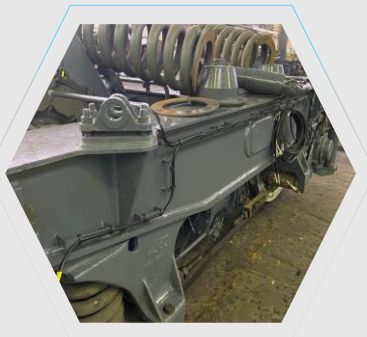
Кабельная сеть на специально наваренных монтажных скобах
