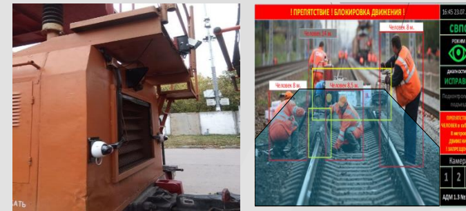
Пример 3 – Испытания системы обнаружения препятствий на ССПС
