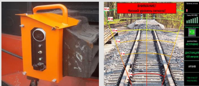
Пример 1 – Испытания системы помощи при движении вагонами вперед
