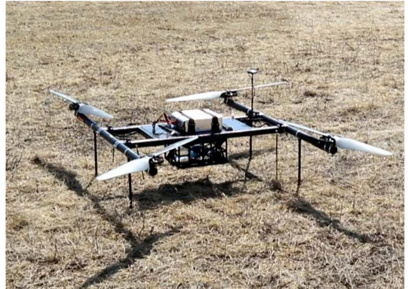
Квадрокоптер, оснащенный системой сброса груза, весом до 3 кг.
