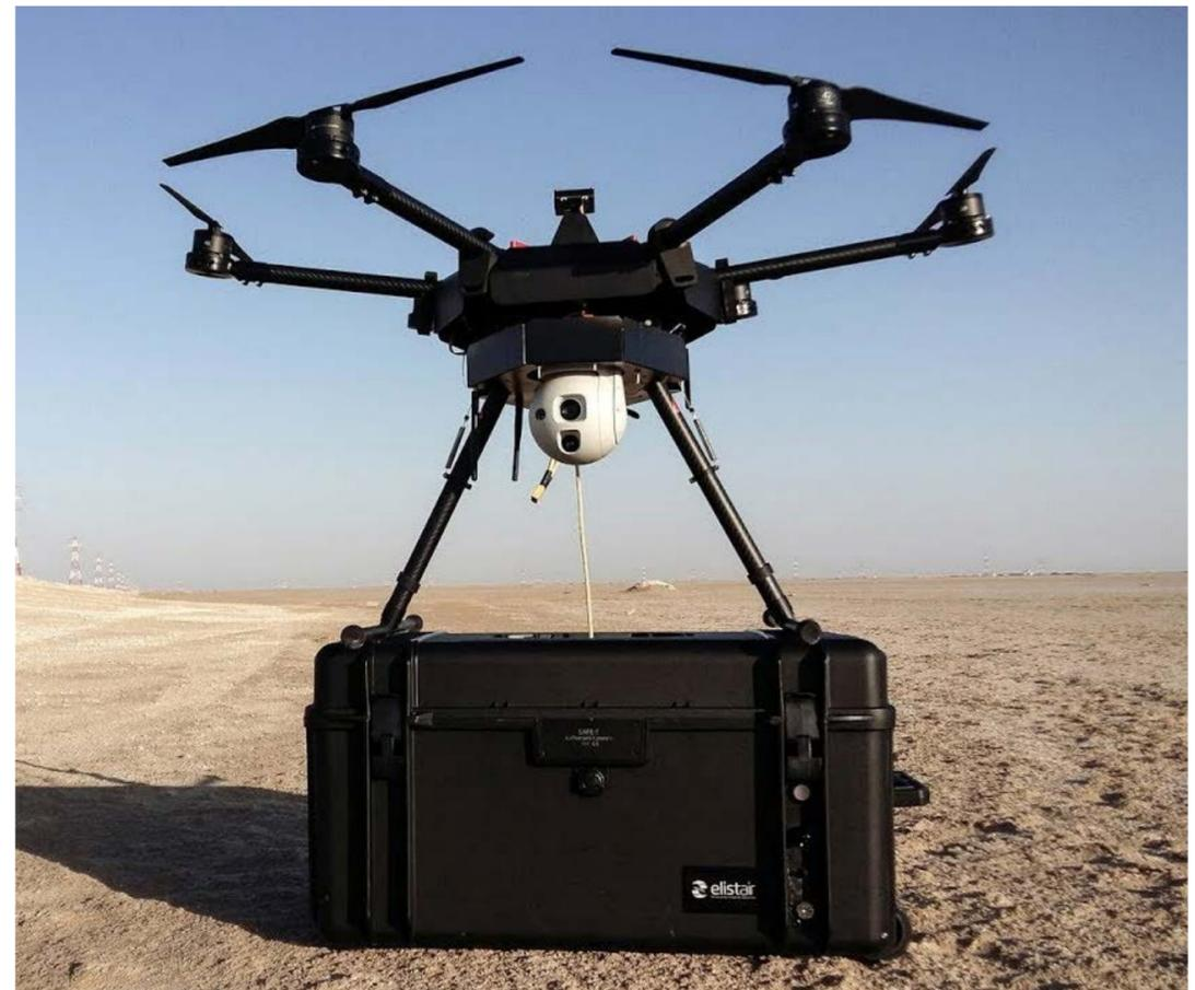
Привязной мультикоптер – трансляция видеопотока по кабелю, наземная обработка с применением сервера с ИИ.
