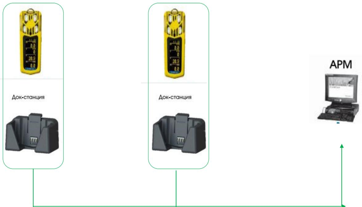
Существующей вариант работы с индивидуальными газоанализаторами, по окончании работы газоанализатор устанавливается на док-станцию где происходит зарядка и снимаются показатели с передачей данных в систему что позволяет контролировать правильность действий персонала при превышении ПДК.
